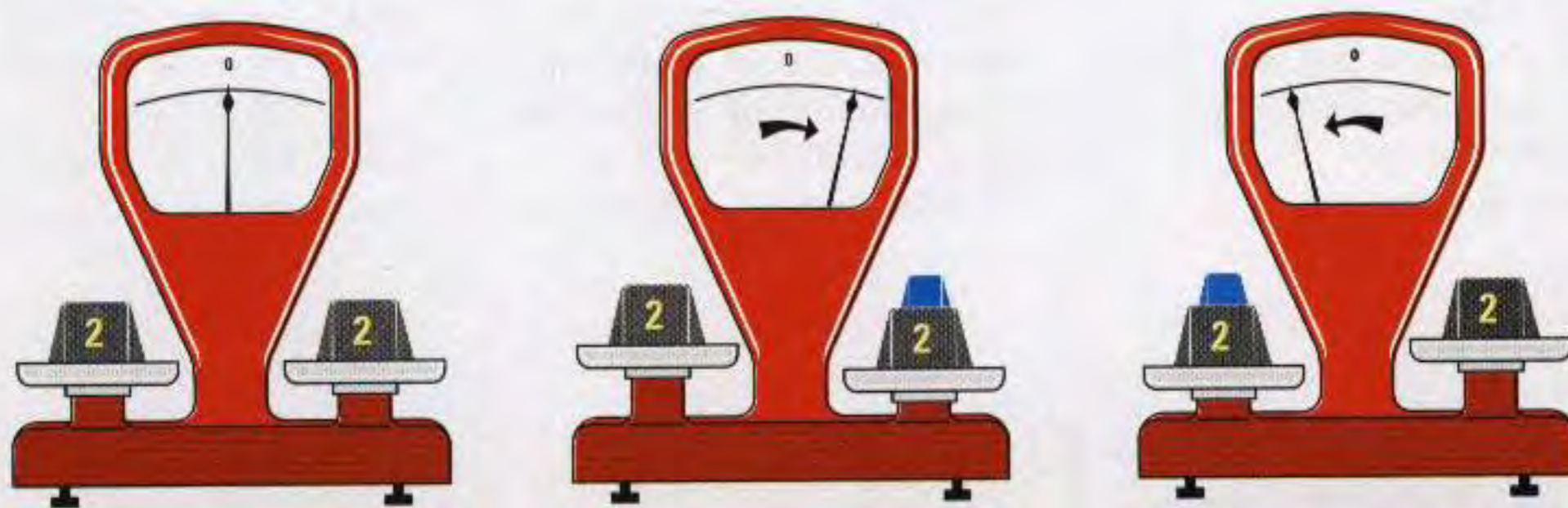
Fig.2 Possiamo paragonare il differenziale ad una bilancia con 0 centrale provvista di due piatti. Se nei due piatti poniamo due identici pesi, non importa se da 50 grammi o da 2 chilogrammi, l'ago rimarrà immobile sullo 0 centrale. Se sul piatto di destra poniamo un peso leggermente maggiore, l'ago della bilancia devierà verso destra, mentre se lo poniamo sul piatto di sinistra, l'ago della bilancia devierà a sinistra.
