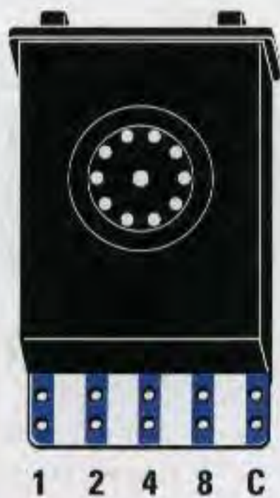
Fig.12 Per sintonizzare il VFO su una frequenza fissa potete escludere i commutatori binari e fare dei ponticelli sulle piste del circuito stampato.
